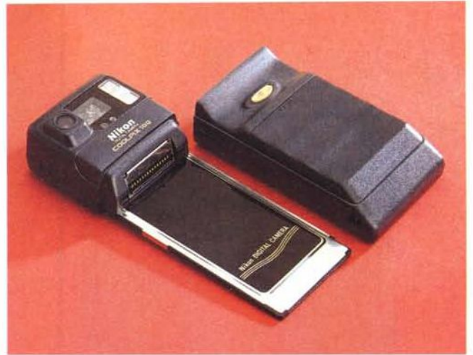
Il lato superiore dell'impugnatura contiene le quattro pile stilo per l'alimentazione della macchina. Rimuovendola completamente scopriamo la sua appendice PCMCIA per il trasferimento delle immagini riprese su computer.
